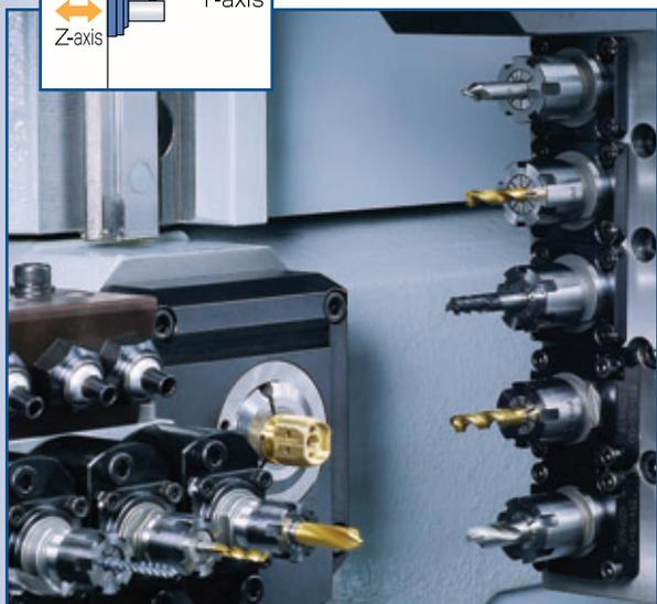
Pour les opérations transversales, la machine dispose de cinq outils tournants destinés au perçage, fraisage, fraisage de fentes etc.
